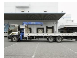
【15t ユニック】 最大積載量:12,300~13,000kg 積載可能パレット枚数:16 枚
