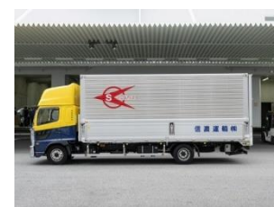
【4t ウイングゲート】 最大積載量:2,500~2,700kg 積載可能パレット枚数:8~10 枚
