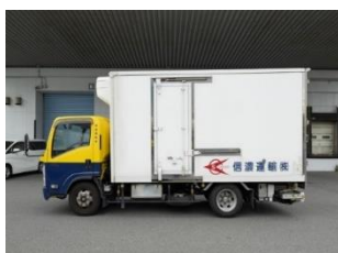
【3t 冷凍・冷蔵】 最大積載量:3,000kg 積載可能パレット枚数:3 枚
