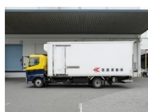
【4t 冷凍・冷蔵】 最大積載量:2,500~2,750kg 積載可能パレット枚数:5 枚
