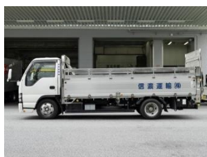
【2t 平ゲート】 最大積載量:2,000kg 積載可能パレット枚数:3 枚
