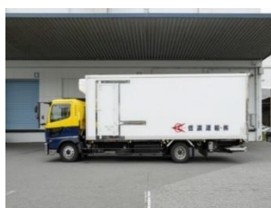
【4t 冷凍・冷蔵ゲート】 最大積載量:2,300~2,900kg 積載可能パレット枚数:10 枚
